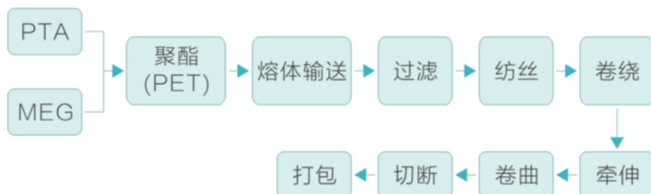
图1-2 熔体直纺短纤生产工艺
