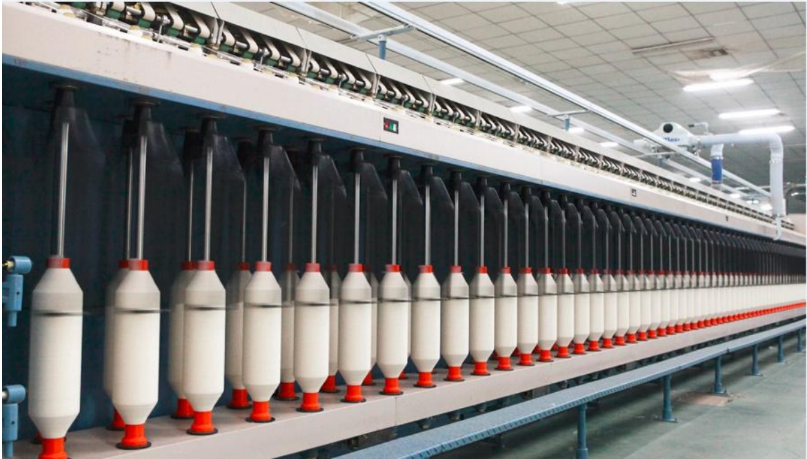
图6 粗纱工序示意图
